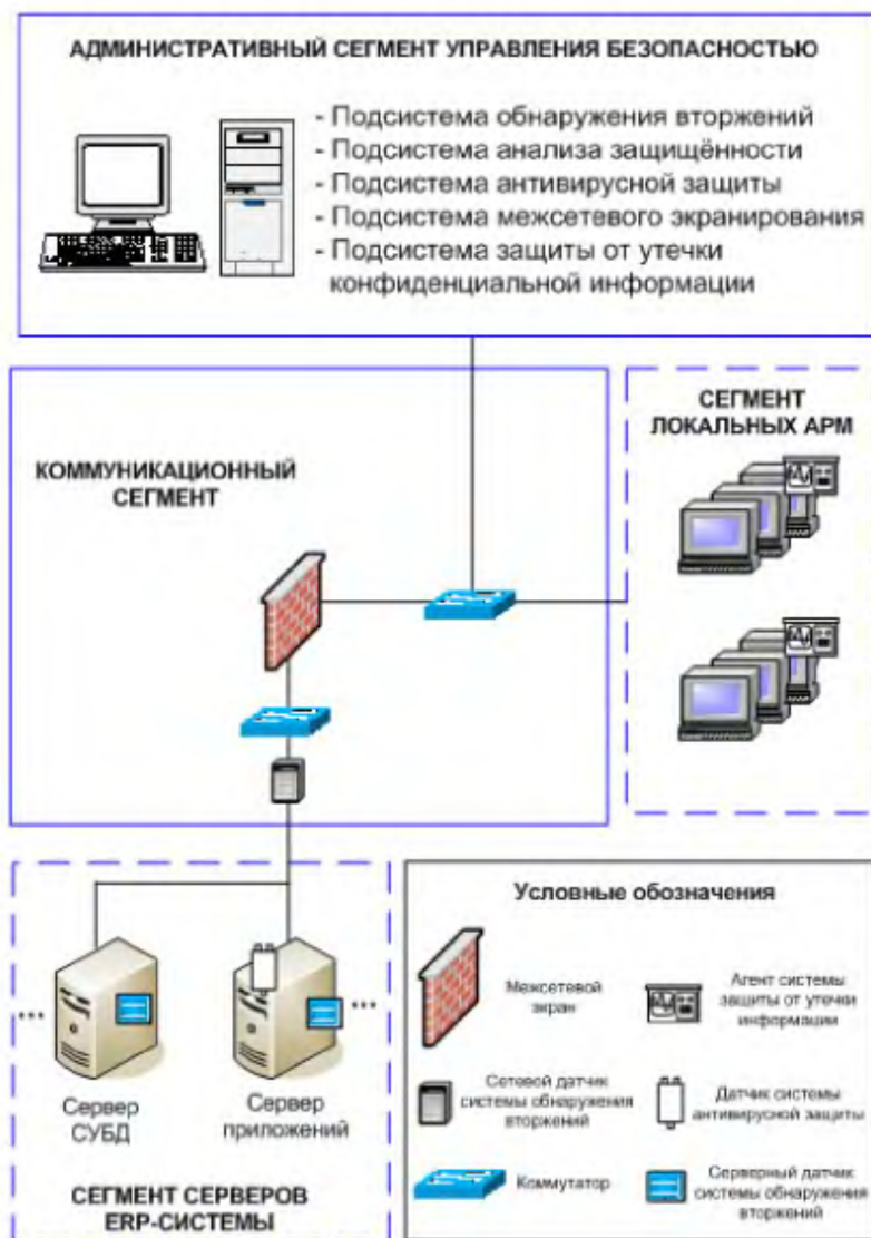
Рис 5. Схема размещения средств защиты ERP-системы Компоненты решения
