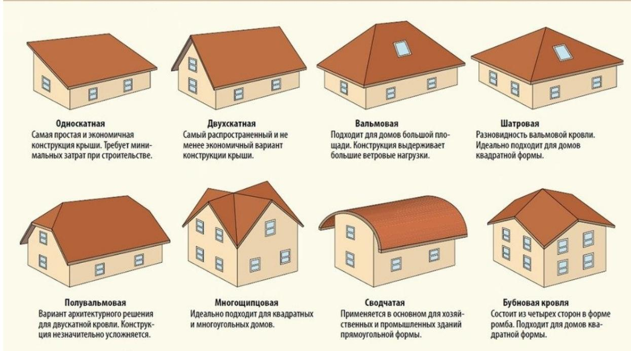
Рисунок 17. Примеры конструкций крыш [33]
