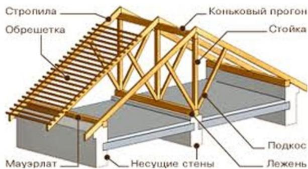
Рисунок 18. Стропильная система [34]
